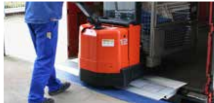
Transpalettes électrique (Charge maximum 2500 kg - Pente max. 8%*)
