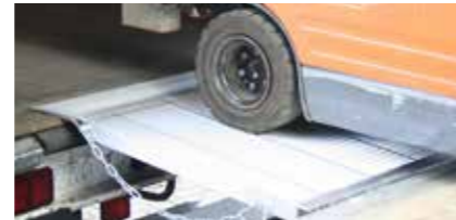
Chariot élévateur (Charge maxi. 6000 kg - Pente maximum 10%*)
